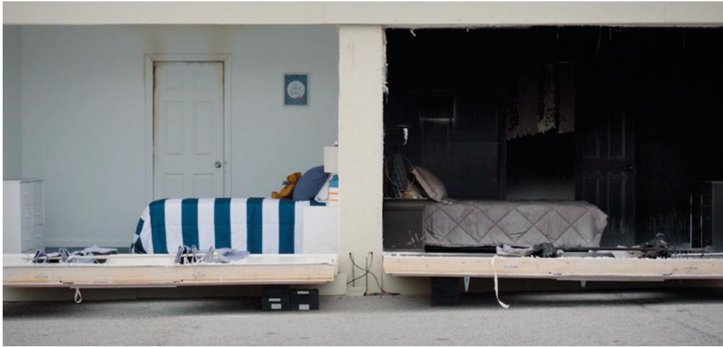
Incendie d'un logement avec une chambre porte fermée (gauche) et une chambre porte ouverte (droite).
